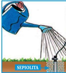
Se puede utilizar **bentonita** o **sepiolita** ( arena para gatos ) en el hueco donde se clave la piqueta ya que estos materiales absorbentes retienen el agua durante bastante tiempo.
