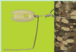
**Conexión del cable de línea:** Pase el cable de línea a través del aislador A20 y forme una manivela para realizar un nudo de 5 vueltas. En este caso podemos dejar el sobrante para realizar un puente eléctrico fácil.
