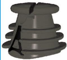
Aislador para cable / hilo. Se fija a un poste mediante ligadura o en la parte superior de una piqueta de 12 mm de Ø enroscándolo.
