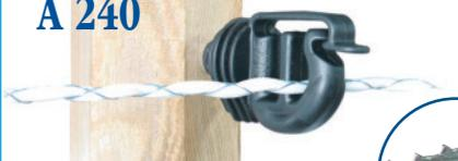
Aislador con tirafondo con punta especial para madera. Cierre de seguridad mediante clip. Se puede utilizar para hilos, cordones hasta 8 mm. y cintas hasta 20 mm.
